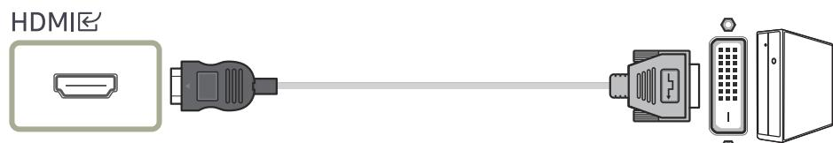
— При использовании кабеля HDMI-DVI звук может воспроизводиться в формате, отличном от формата на устройстве-источнике.
