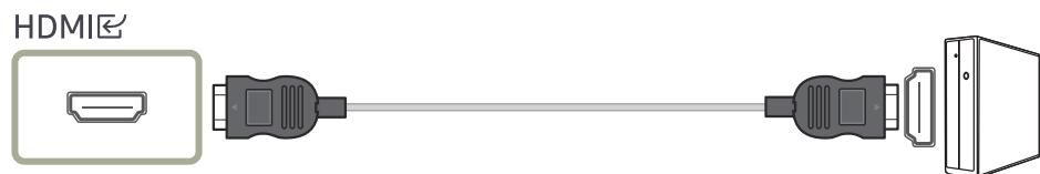
— Рекомендуется использовать кабель HDMI, входящий в комплект поставки. Если его нет в комплекте поставки, используйте разрешенный кабель для кабельных подключений через порт HDMI. При использовании неразрешенного кабеля HDMI качество изображения может ухудшиться.
