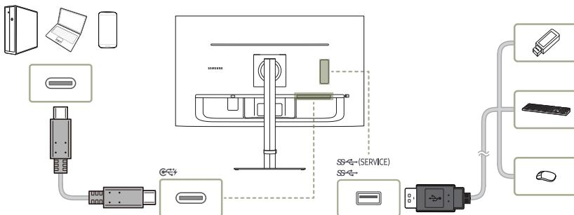
При использовании изделия в качестве концентратора к изделию можно одновременно подключать и использовать различные устройства.
