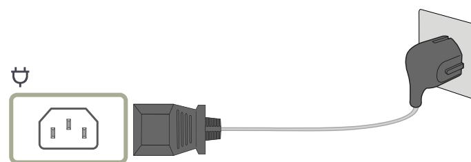
Для работы с устройством подключите кабель питания к электрической розетке и порту на устройстве.
