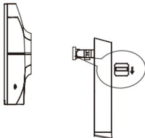
Панель монитора фиксируется на стойку с помощью защелки
