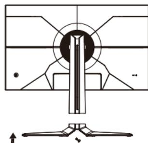
Для прикрепления основания используйте винт крепления
