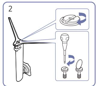
Полностью закрутите соединительный винт в нижней части подставки, чтобы как следует зафиксировать соединительный элемент.
