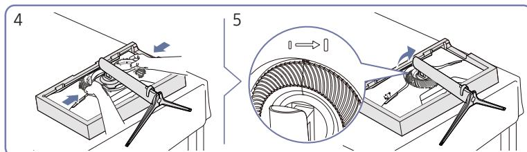
Установите декоративную крышку, сдвинув ее в направлении, обозначенном стрелками, затем поверните ее по часовой стрелке согласно отметке.
