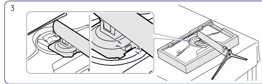
Затяните большой винт в середине, чтобы собрать конструкцию вместе.
