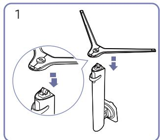
Поместите подставку в соединительный элемент, как показано на рисунке. Проверьте, надежно ли закреплен соединительный элемент подставки.
