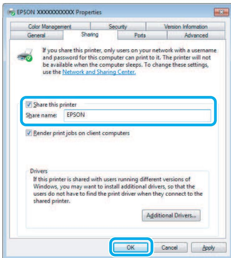
Если вы хотите, чтобы драйверы принтера автоматически загружались для компьютеров под управлением различных версий ОС Windows, щелкните **Additional Drivers (Дополнительные драйверы)** и выберите среды и операционные системы для других компьютеров. Нажмите **OK**, затем вставьте диск с ПО для устройства.
