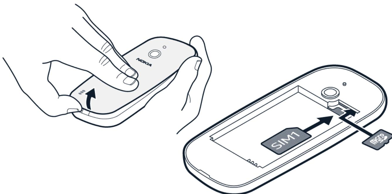
1. Вставьте ноготь в небольшой разъем в нижней части телефона, поднимите и снимите крышку.
