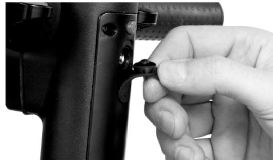
Для зарядки электросамоката открой защитный колпачок. Вставь штекер зарядного устройства в гнездо зарядки электросамоката. После этого воткни вилку зарядного устройства в розетку электросети. Во время зарядки индикатор на зарядном устройстве будет гореть
