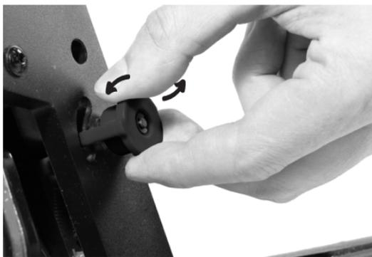
2. Освободи боковой фиксатор безопасности: потяни за него и поверни против часовой стрелки до упора.
