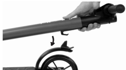
3. Сложи электросамокат, опустив руль на заднее крыло до щелчка. Крючок должен войти в зацепление с петлёй для складывания.
