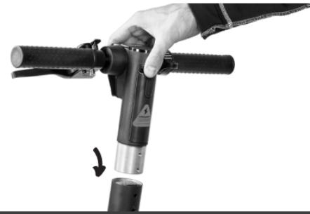
7. Аккуратно вставь руль в рулевую колонку до упора, совместив отверстия в рулевой колонке с резьбовыми отверстиями в руле.
