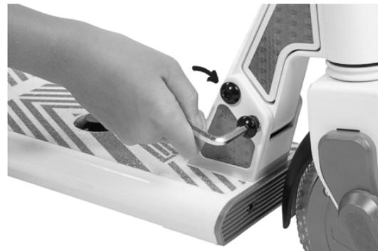
3. При помощи шестигранного ключа затяни винты, соединяющие платформу и рулевую колонку.
