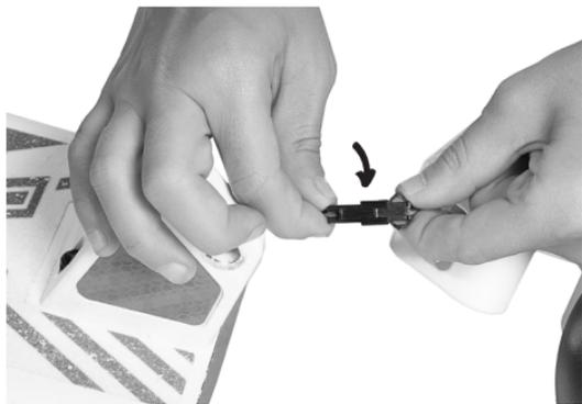
1. Соедини электрический разъем между платформой и рулевой колонкой.
