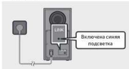
Светодиодный индикатор **LINK** прекращает мигать и непрерывно подсвечивается синим цветом, когда между Soundbar и беспроводным сабвуфером установлено соединение.
