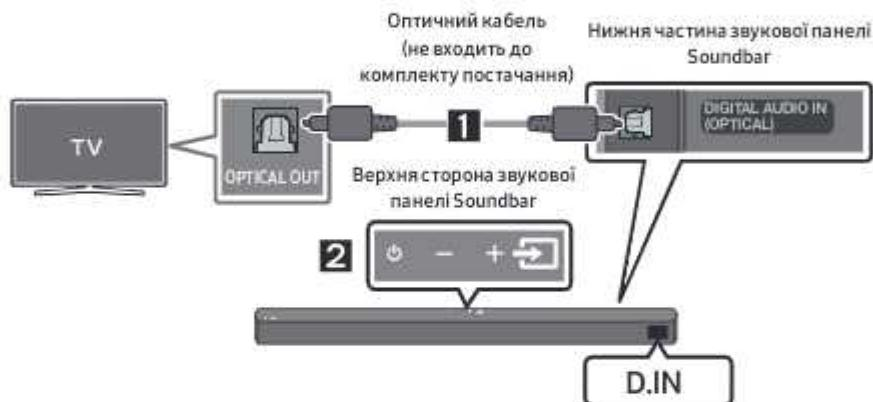
1. З'єднайте роз'єм **DIGITAL AUDIO IN (OPTICAL)** на звуковій панелі Soundbar з **OPTICAL OUT** на телевізорі за допомогою цифрового оптичного кабелю (не входить до комплекту постачання).
