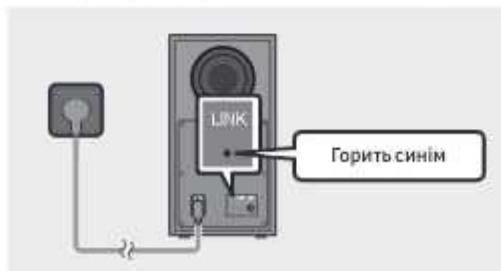
Після встановлення підключення між звуковою панеллю Soundbar та бездротовим сабвуфером світлодіодний індикатор **LINK** припинить блимати й горіти неперервно синім світлом.
