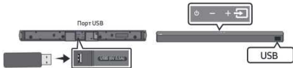
1. Подключите USB устройство к USB разъему на нижней панели устройства.
