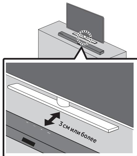
Совместите центр устройства Soundbar с центром телевизора в соответствии с рисунком, а затем осторожно расположите устройство Soundbar на подставке телевизора.
