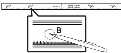
**4. Используя сверло соответствующего размера, просверлите отверстие в стене на каждом обозначенном месте.**
