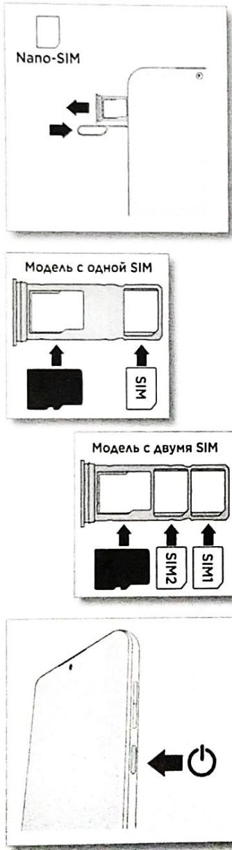
**1** Вставьте специальный инструмент для извлечения SIM в отверстие рядом с лотком, чтобы выдвинуть его.
