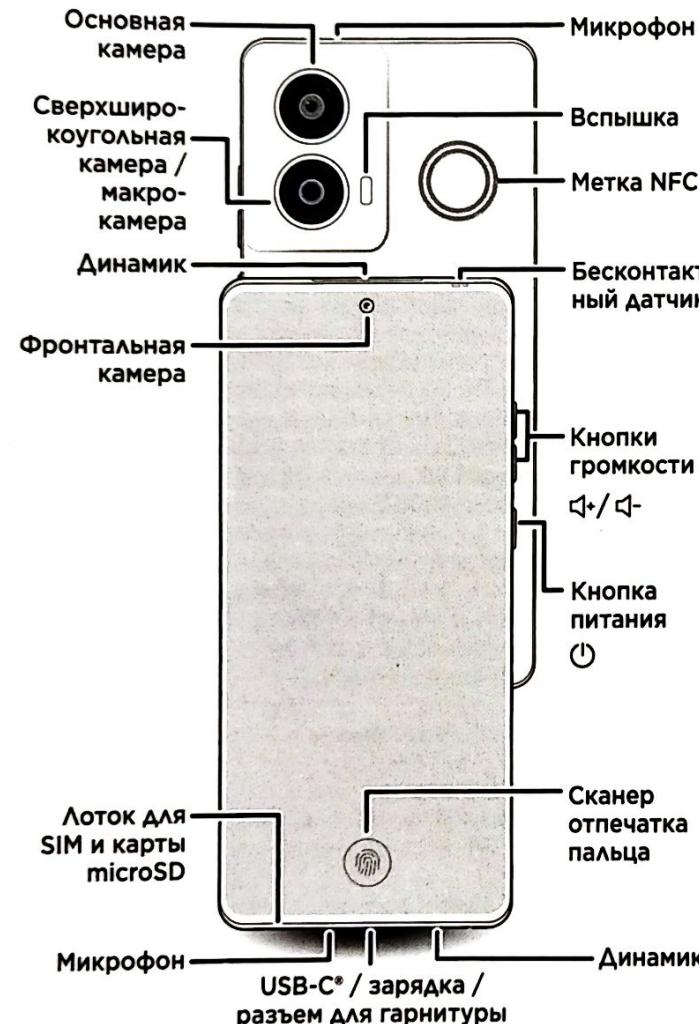
**Примечание.** Для использования требуется гарнитура с разъемом USB-C. В случае использования гарнитуры с разъемом 3,5 мм вам потребуется адаптер для его подключения к разъему USB-C. Гарнитуру и адаптер можно приобрести отдельно.
