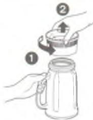
Поверните базу контейнера блендера в направлении против часовой стрелки, чтобы снять ее.
