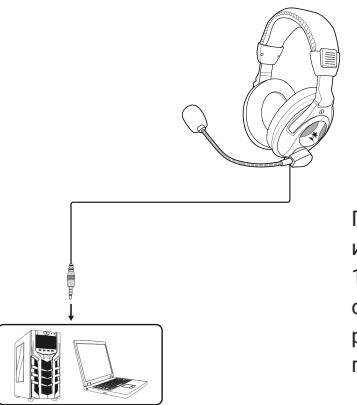
Гарнитуру можно использовать с ПК или ноутбуками, имеющими разъем 1 x 3.5мм мини-джек. Для использования с ПК и ноутбуками, оснащенными типом разъемов 2 x 3.5мм мини-джек - необходим переходник (не идет в комплекте с гарнитурой).
