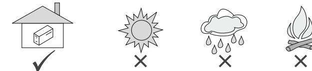
Устройство предназначено только для использования внутри помещения. Внимательно ознакомьтесь с инструкциями во избежание перегрева, попадания пыли, влаги или жидкостей.
