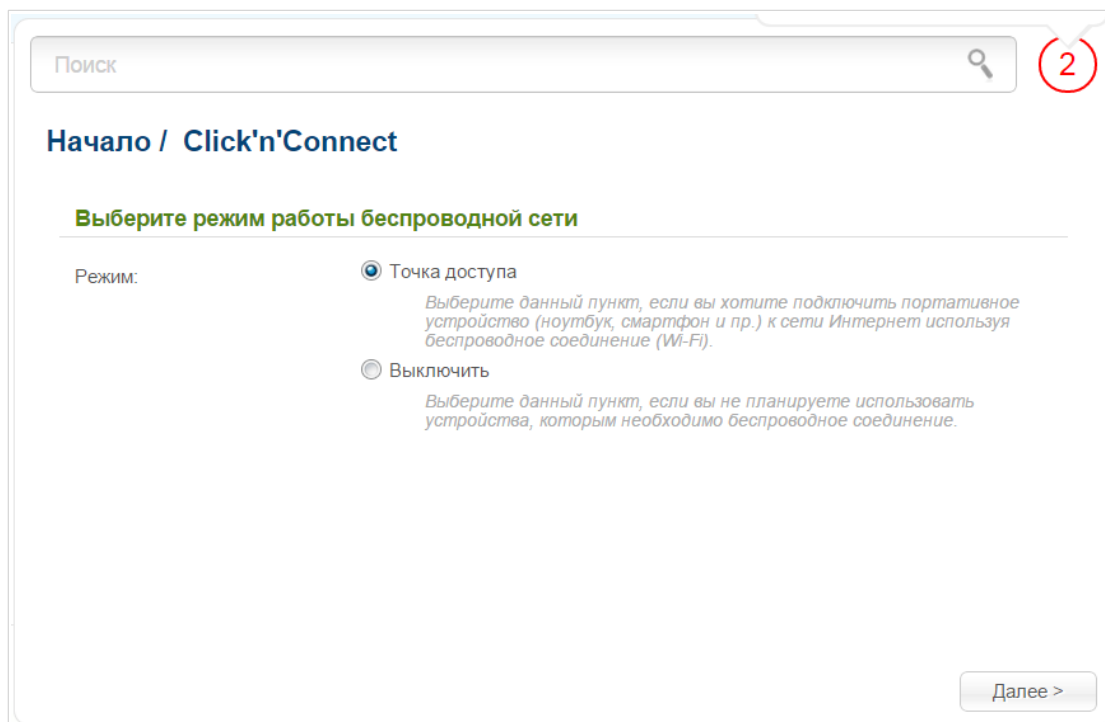
Рисунок 43. Выбор режима работы беспроводной сети.
