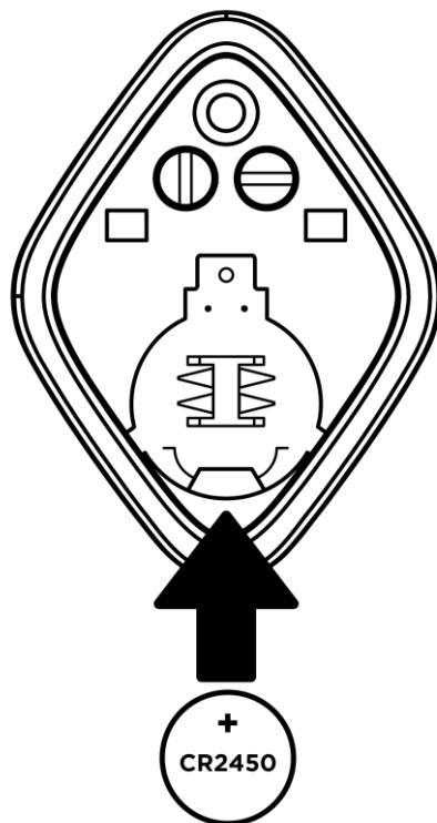
**Рисунок 8 – Ориентация батарейки при вставке в датчик движения**
