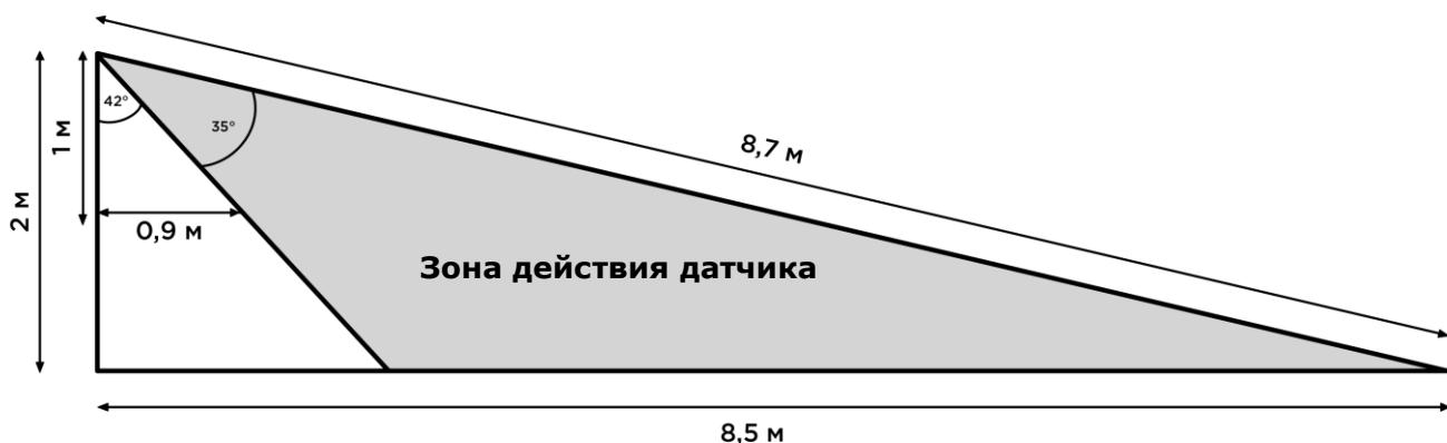
3-в – Детализация угла обзора по вертикали
