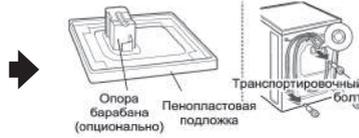
Снимите транспортировочные болты и опоры.
