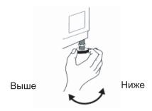
7. Важно!Хорошо затяните контргайку, вращая ее против часовойстрелки по направлению к корпусу.
