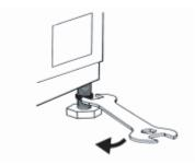
6. Немного приподнимите машину и,вращая ножку, отрегулируйте ее высоту.
