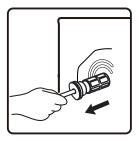
4. Для безопасности и снижения шума установитезаглушки транспортировочных винтов, которые поставляются вместе с машиной (см. комплект поставки). Вставьтезаглушки транспортировочных винтов в отверстия и нажмите в направлении, как показано на рисунке, до щелчка.
