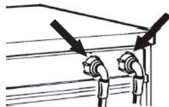
10. Вручную прикрутите шланг к крану, затягивая для этого гайку.
