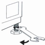
6. Немного приподнимите машину и, вращая ножку, отрегулируйте ее высоту.
