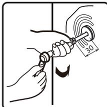
2. Толкните четыре транспортировочных винта горизонтально внутрь машины и ослабьте их.
