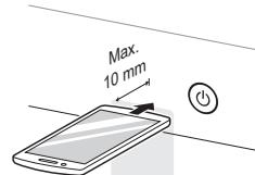
**3** Смартфон микрофонын деректердің тасымалдануы аяқталғанға дейін **Құат** түймесіне жақындағы ұстап тұрып, **Отжим (Сығу)**, **Температура (Темп.)** және **Таймер (Таймер)** түймелерін 3 немесе одан көп секунд басып тұрыңыз.
