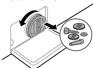
**5** Очистите фильтр насоса и отверстие с помощью щетки.
