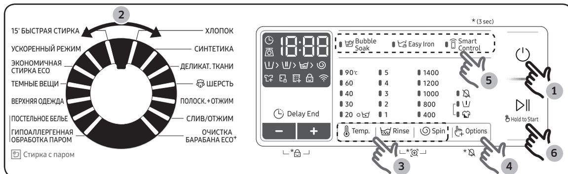
1. Включите стиральную машину нажатием на кнопку **Вкл./Выкл.**
