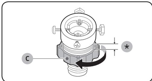
3. Возьмитесь за адаптер и поверните его часть (С) в указанном стрелкой направлении, вывинтив его на 5 мм (\*).
