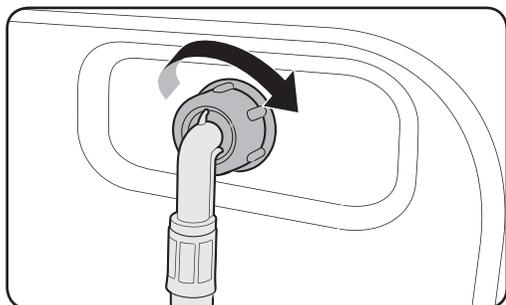
8. Подсоедините другой конец шланга подачи воды к впускному клапану, расположенному на задней стенке стиральной машины. Заверните шланг по часовой стрелке до упора.
