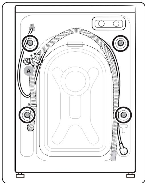
3. Наденьте пластиковые колпачки на головки всех болтов, находящихся на задней стенке стиральной машины.
