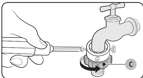
4. Вставьте адаптер в водопроводный кран и затяните винты, поднимая адаптер вверх.
