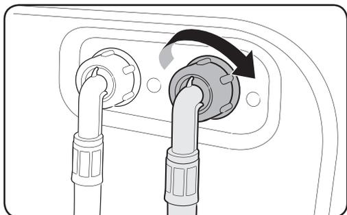
1. Подсоедините красный конец шланга подачи горячей воды к месту ввода горячей воды на задней стенке стиральной машины.
