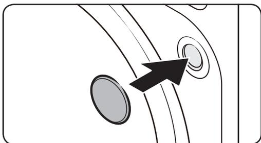
2. Закройте болтовые отверстия с помощью прилагаемых пластмассовых колпачков. Сохраните транспортировочные болты для последующего использования.
