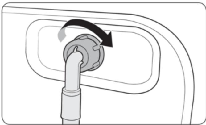
1. Подсоедините шланг для подачи воды к водопроводному крану, затем поверните соединитель по часовой стрелке, как показано на рисунке.
