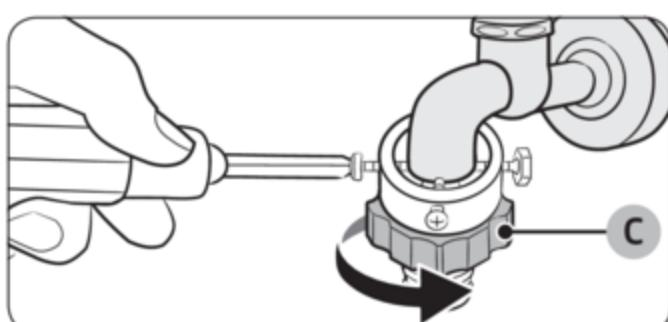
4. Наденьте адаптер на водопроводный кран, затем затяните винты, одновременно приподнимая адаптер.
