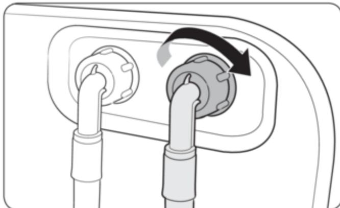
1. Подсоедините конец шланга для подачи воды красного цвета к впускному отверстию горячей воды на задней панели стиральной машины.
