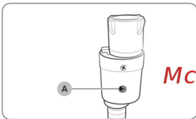
Шланг Aqua Stop обеспечивает оповещение пользователей об опасности протечки воды. Он измеряет поток воды и при появлении риска утечки воды изменяет цвет индикатора (A) в центре на красный.
