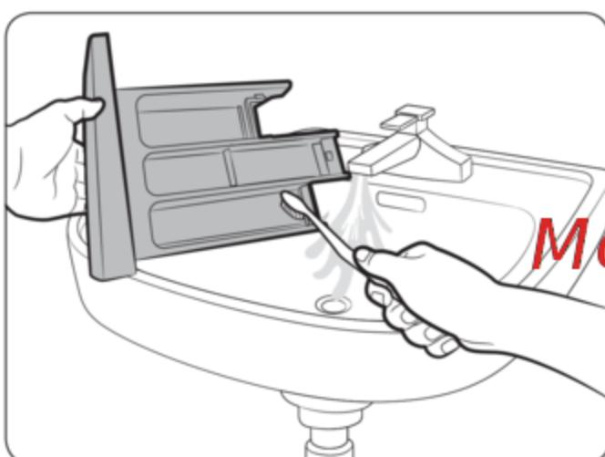
3. Промойте компоненты дозатора в проточной воде с помощью мягкой щетки.
