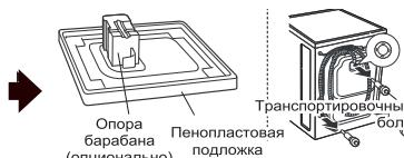
Снимите транспортировочные болты и опоры.
