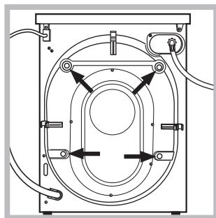
3. Видаліть 4 запобіжні гвинти для транспортування та прокладку з відповідною розрірною деталлю, які знаходяться позаду (див. малюнок).
