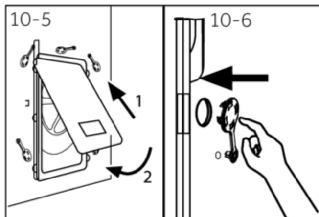
3. Заново установите заднюю крышку, вставив ее в два отверстия, обращенных выступающей частью наружу (рис. 10-5).
