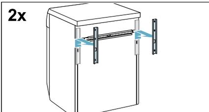
3. Выверните и снимите винты с горизонтальной транспортировочной планки.
