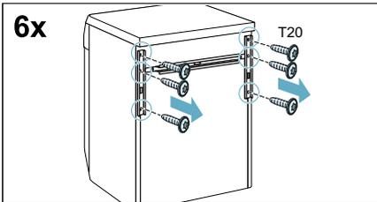
2. Снимите транспортировочные планки.
