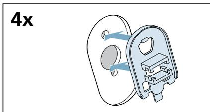
4. Зафиксируйте заглушки нажатием на стопорные крючки.
