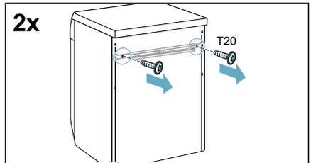
4. Снимите транспортировочную планку.
