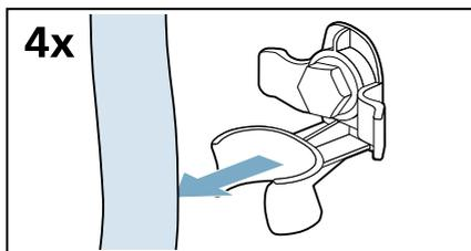
2. Отверните и снимите все винты четырёх транспортировочных креплений.
