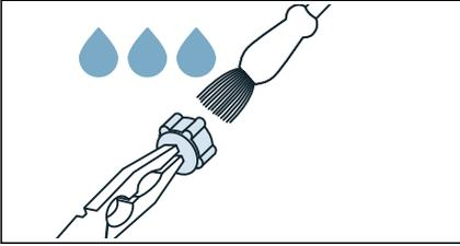
4. Подсоедините шланг и проверьте герметичность соединения.
