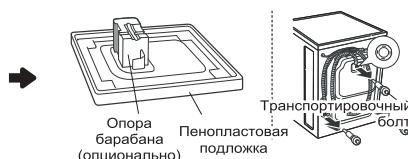
Снимите транспортировочные болты и опоры.
