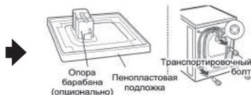
Снимите транспортировочные болты и опоры.
