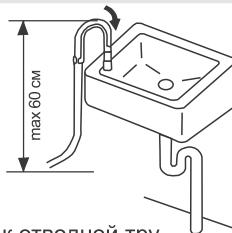
Возможно подсоединение шланга к отводной трубе канализационного стока, имеющей диаметр не менее наружного диаметра шланга и высоту не более 60 см.
