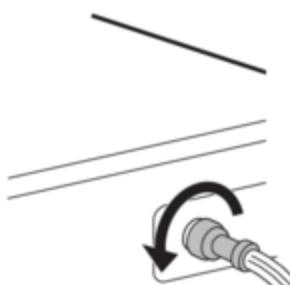
**2** Извлеките впускной фильтр подачи воды с помощью небольших щипцов и очистите
