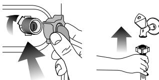
1. Затяните все гайки вручную. Не используйте для затяжки гаек гаечный ключ.
