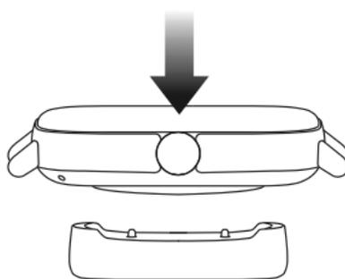
Это изделие заряжается от магнитной зарядной базы. Используйте зарядную базу из комплекта поставки. Соедините разъем для зарядки на задней панели часов с металлическими контактами зарядной базы. При правильной установке на экране часов появится индикатор уровня заряда.
