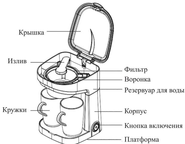
Работа кофеварки запускается кнопкой включения. По окончании приготовления повторным нажатием на кнопку включения кофеварка выключается. Если не выключить ее вручную, то кофеварка выключится автоматически через 7 минут после начала работы.
