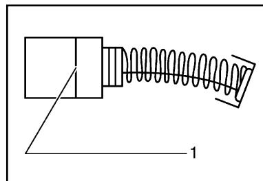
Следует всегда содержать угольные щётки в чистоте и следить за тем, чтобы они свободно скользили в пределах щёткодержателей, это позволит избежать залипания угольной щетки и обеспечит хороший контакт с коллектором ротора.
