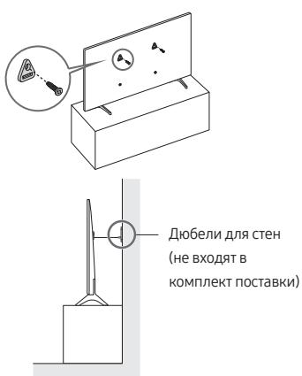
1. С помощью винтов соответствующего размера надежно прикрепите к стене набор кронштейнов. Убедитесь, что винты надежно закреплены на стене.
