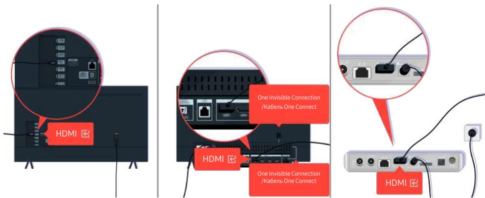
Проверьте подключение кабеля HDMI к ТВ или приставке One Connect.
