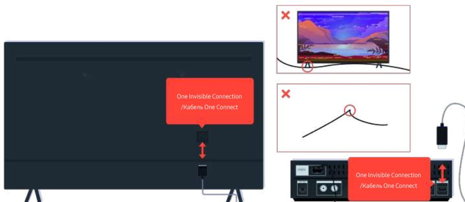
Если устранить проблему не удается и для ТВ используется One Invisible Connection или Кабель One Connect, отсоедините и снова подсоедините One Invisible Connection или Кабель One Connect к ТВ и приставке One Connect. Убедитесь, что One Invisible Connection или Кабель One Connect не защемлен и не перегнут.
