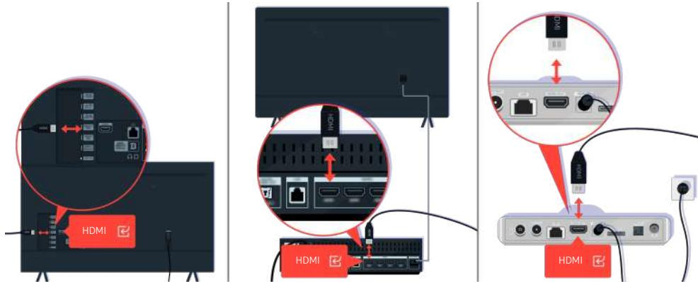
Проверьте подключение антенны и кабеля HDMI.
