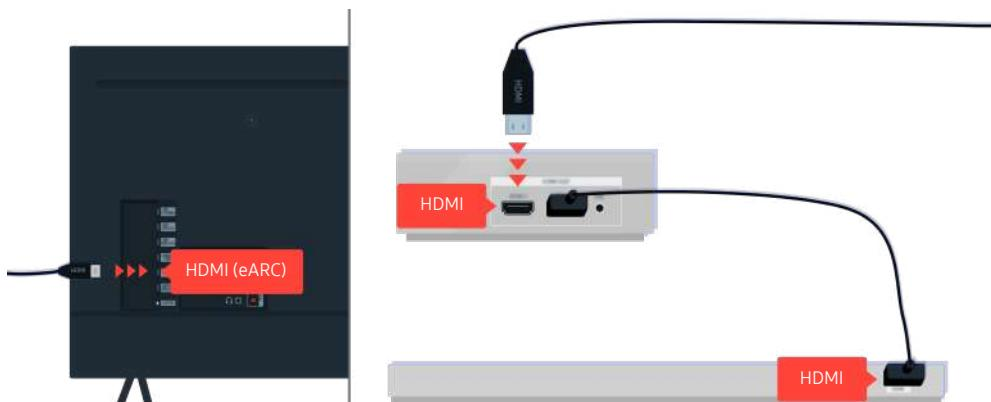
Если звуковая панель подключена к ресиверу, а ресивер подсоединен к ТВ с помощью кабеля HDMI, проверьте разъем HDMI с обратной стороны ТВ. Кабель должен быть подключен к порту HDMI (eARC) на ТВ.
