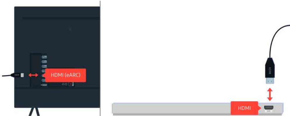
Если из звуковой панели нет звука и она подключена к ТВ с помощью кабеля HDMI, проверьте разъем HDMI (eARC) с обратной стороны ТВ.
