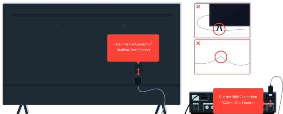
Отсоедините и снова подсоедините One Invisible Connection или Кабель One Connect которым ТВ подключен к приставке One Connect. Убедитесь, что One Invisible Connection или Кабель One Connect не защемлен и не перегнут.
