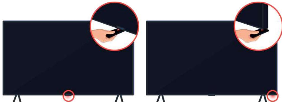
Датчик пульта ДУ можно увидеть, если поднести предмет с отражающей поверхностью, например зеркало, под ТВ.
