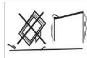
Не устанавливайте устройство на неустойчивые тележки, стойки, полки или столы. Падение может привести к повреждению устройства, а также стать причиной физических травм человека.
