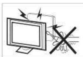
Висока напруга виробляється в процесі роботи цього телевізійного пристрія. Не знімайте з пристрою задню панель. Технічне обслуговування та ремонт внутрішніх компонентів пристрію повинні проводити тільки кваліфіковані спеціалісти.
