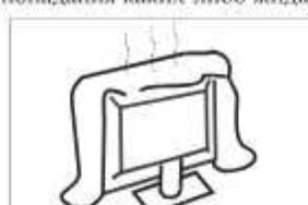
Не перекрывайте вентиляционные отверстия задней панели. Для длительной и беспроблемной эксплуатации электрокомпонентам требуется охлаждение.
