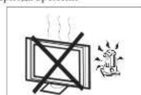
Не подвергайте телевизионный приемник воздействию прямых солнечных лучей и других источников тепла. Не устанавливайте телевизионный приемник непосредственно на другие устройства, которые выделяют тепло, например на видеоплееры и аудиоусилители. Не устанавливайте на телевизоре источники открытого огня, например зажженные свечи.
