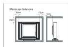
При вбудованому встановленні телевізора необхідно дотримуватися зазначеної мінімальної відстані до стін. Перегрів призведе до пошкодження та скорочення терміну служби пристрію.
