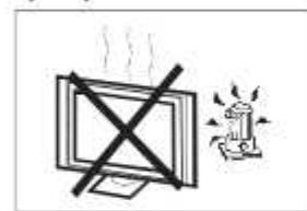
Не піддавайте телевізійний пристрій впливу прямих сонячних променів та інших джерел тепла. Не встановлюйте телевізійний пристрій безпосередньо на інші вироби, які виділяють тепло, наприклад на відеопрограмачі та звуковому підсилювачі. Не слід розміщувати на телевізорі джерела відкритого вогню, наприклад, запалені свічки.
