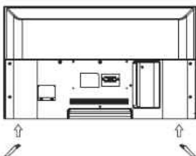
2. Вставьте длинные винты в отверстия на задней панели телевизора, соответствующие отверстиям в прямоугольной части металлических опор, затем плотно затяните винты. Для максимальной фиксации спектра прижмите металлические опоры в процессе затяжки.
