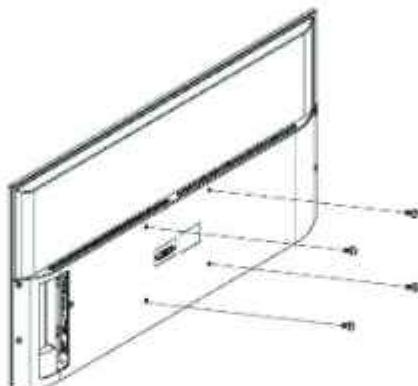
**Шаг 3:** Зафиксируйте ЖК-телевизор с помощью винтов для настенного монтажа на кронштейнах.
