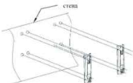
**Шаг 2:** Вкрутите винты для настенного монтажа M 6 x 12 мм в заднюю стенку ЖК-телевизора с помощью ключа с моментом 8 кгс\*см.
