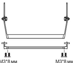
3. Закрепите собранную подставку в нижней части телевизора с помощью винтов.
