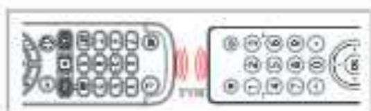
1. Umiestnite pôvodný diaľkový ovládač na plochý povrch čelom k ovládaču One For All.
