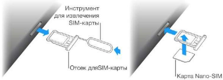
**Открытие гнезда SIM-карты.** Вставьте конец инструмента (приобретается отдельно) для извлечения SIM-карты в отверстие гнезда, затем нажмите с усилием, пока гнездо не выскочит наружу. Вытяните гнездо SIM-карты и установите или замените SIM-карту. При отсутствии инструмента для извлечения SIM-карты можно использовать конец канцелярской скрепки.
