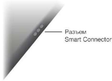
С помощью разъема Smart Connector к iPad Pro можно подключать аксессуары, например клавиатуру Smart Keyboard. Подробную информацию о клавиатуре Smart Keyboard для iPad Pro см. на веб-странице [support.apple.com/ru-ru/HT205237](http://support.apple.com/ru-ru/HT205237).
