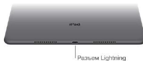
Подключите кабель Lightning-USB к разъему Lightning, чтобы зарядить или синхронизировать iPad. Подробную информацию о заряжании см. в разделе [Зарядка аккумулятора и проверка заряда](#). Подробную информацию о синхронизации см. в разделе [Синхронизация с iTunes](#).
