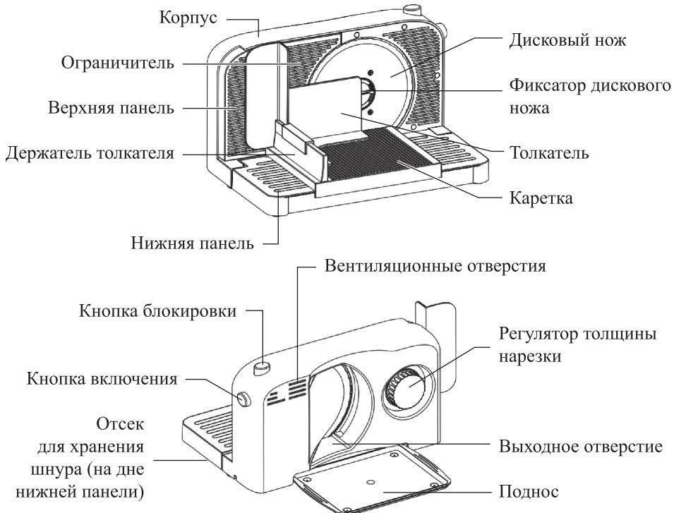
**Корпус** ломтерезки состоит из двух панелей: на **нижней панели** располагается **каретка**, на которую укладывается продукт, на **верхней панели** находится **дисковый нож**. Каретку нужно вручную передвигать по нижней панели до дискового ножа и возвращать обратно. В рабочем положении панели расположены под углом 90° друг к другу. Для компактного и безопасного хранения можно сложить устройство, прижав одну панель к другой.
