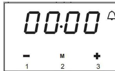
**3.** По истечении запрограммированного времени, прозвучит сигнал. Нажмите на любую кнопку для его отключения, либо сигнал отключится автоматически через 2 минуты
