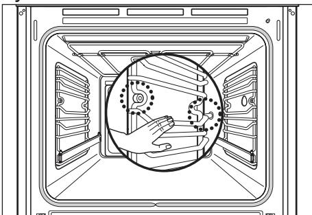
2. Выровняйте переднюю выемку с передним отверстием под винт. Вставьте и вкрутите винт по часовой стрелке.
