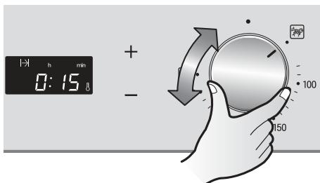
**6** Используя ручку регулятора температуры, установите температуру на EasyClean ( ).
