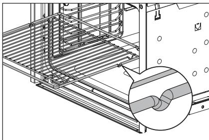
**Механический замок всегда должен смотреть на заднюю часть печи.**
