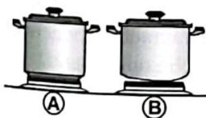
3. Используйте кастрюли с плоским дном. Большая контактная поверхность между элементом и кастрюлей обеспечивает более высокую теплоотдачу. Основание кастрюль должно быть толстым, чтобы не допускать образования вмятин. Как видно из рисунка, кастрюли с вмятинами и выгибами имеют меньшую контактную поверхность (рисунок А – правильно; В – неправильно).
