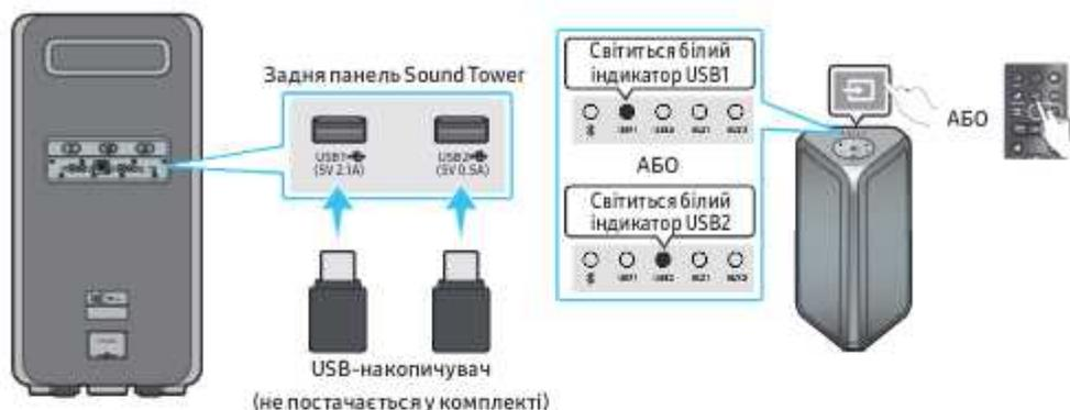
1. Підключіть USB-накопичувач до гнізда USB на Sound Tower.
