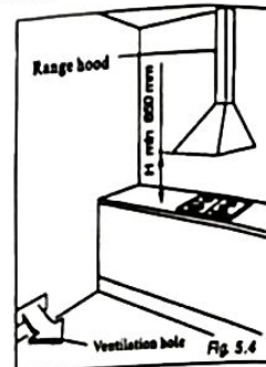
Fig. 5.3 – Рис. 5.3. Clearance – зазор, Cupboard door – дверь шкафа, Space for the link – пространство для соединения, Fig. 5.4 – Рис. 5.4, Range hood – Вытяжка, H 650 mm – высота 650 мм, Ventilation hole – вентиляционное отверстие.
