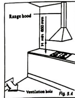
Fig. 5.3 – 5.3-сурет, Clearance – қуыс, Cupboard door – шкафтың есігі, Space for the link – қосылу кеңістігі, Fig. 5.4 – Рис. 5.4, Range hood – Аяа сорғы, H 650 mm – биіктігі 650 мм, Ventilation hole – желдеткіш саңылау.
