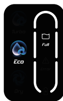
Резервуар для грязной воды заполнен
