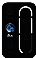
Нормальный заряд батареи
